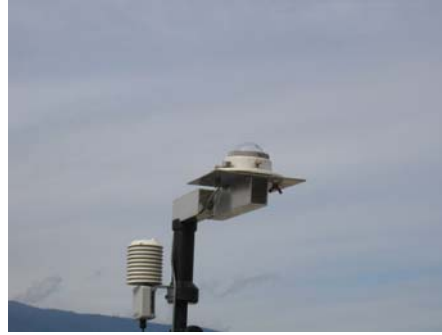
Figure 88 : Pyranomètre stellaire ALMEMO
