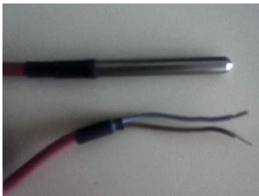
Figure 75 : Sonde de température PT1000, 2 fils
